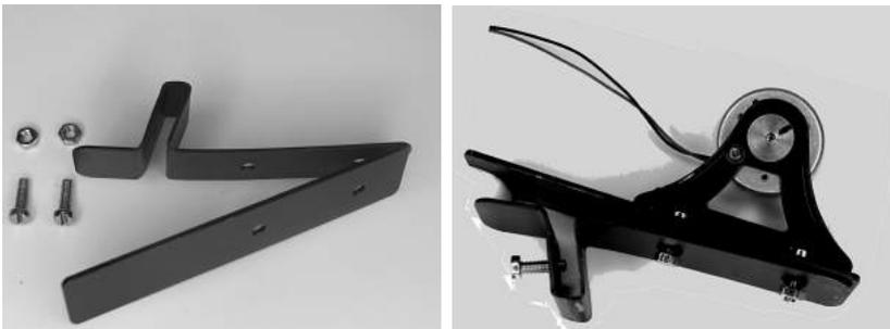
Abb. 3.26: Anbauteile für Generatormontage, a) zweiteiliger Generatorarm, b) Lagerbock und Stellschraube
