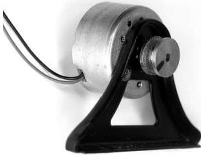
Abb. 3.02: Gleichstrommaschine mit dem Lagerbock verbunden
