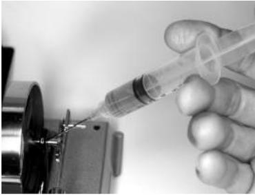
Abb. 2.02: Ölen mit einer Einwegspritze
