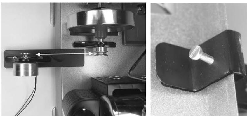
*Abb. 3.27: Generatormontage: a) Riemenräder in der Flucht b) Klemmschraubung, unten an der Grundplatte*
